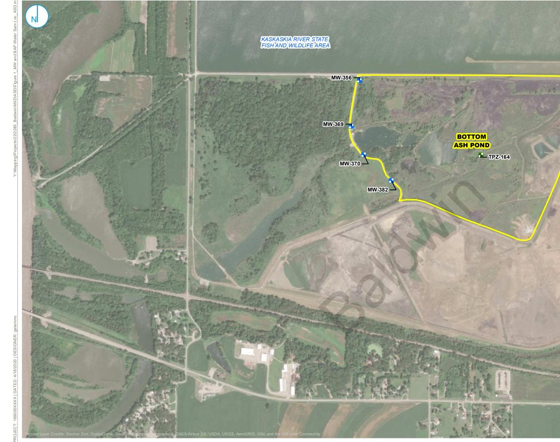
BOTTOM ASH POND DOWNGRADIENT CCR MONITORING WELL LOCATION
